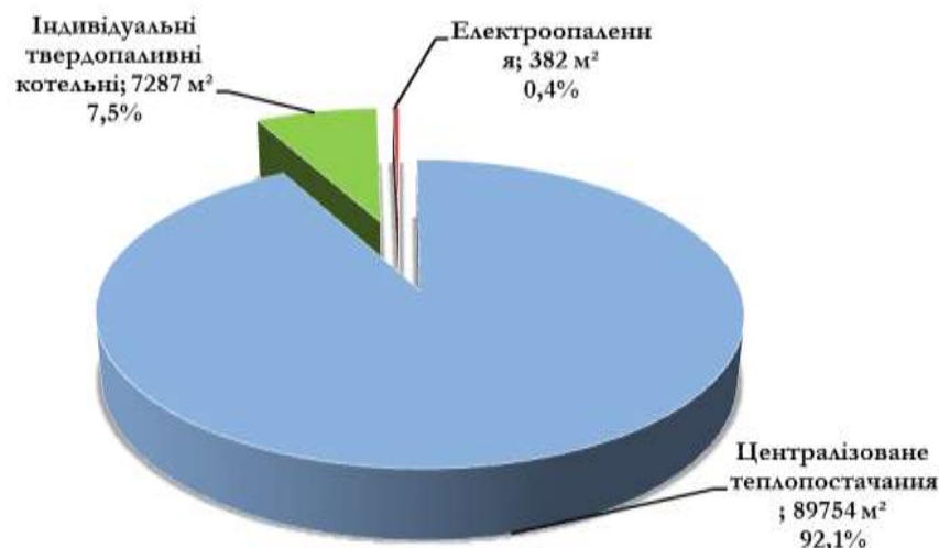
Рисунок 1.6.2. – Розподіл опалювальної площі будівель бюджетної сфери міста Покровськ за джерелом теплоти для потреб опалення
